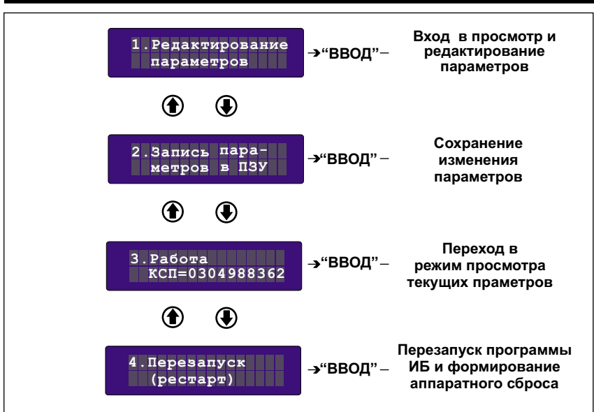
Рисунок 23. Схема управления индикацией режима просмотра и редактирования программируемых параметров.
